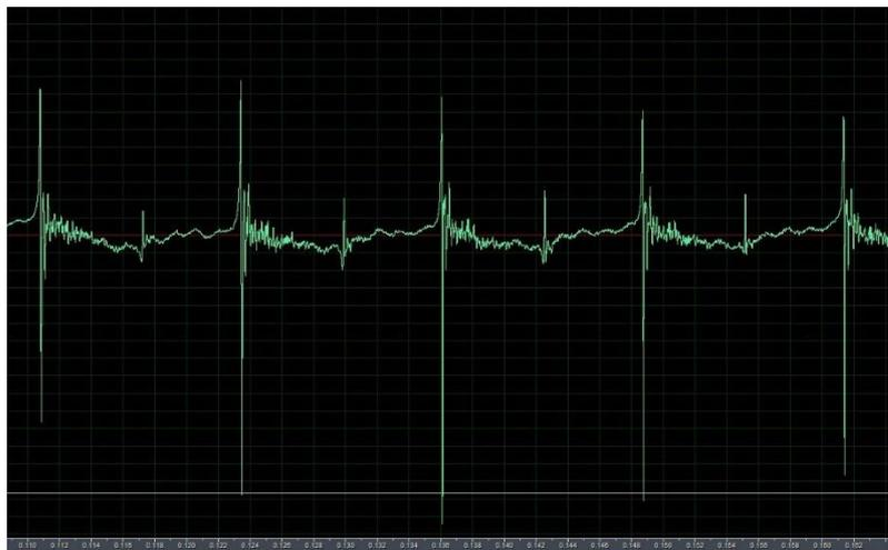
**Рис.2. Осциллограмма изменения давления воздуха около рабочей щели металлического хомуса, где наблюдаем пиковые повышения и понижения давления воздуха при прохождении язычка через ребра дек вовнутрь и, наоборот, из ротовой полости. А. Царь (Хомусчут Андрей).**
